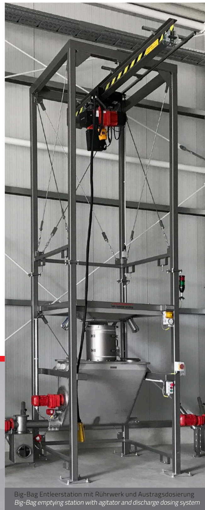
Tandem-Big-Bag Entleerstation mit Trogschnecke Tandem-Big-Bag dischargestation with trough screw
