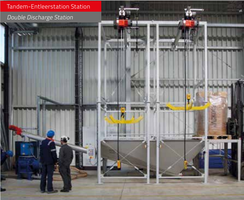
Staubarme Andockstation mit Nachzieh Vorrichtung Dust protected docking station with pulling device
