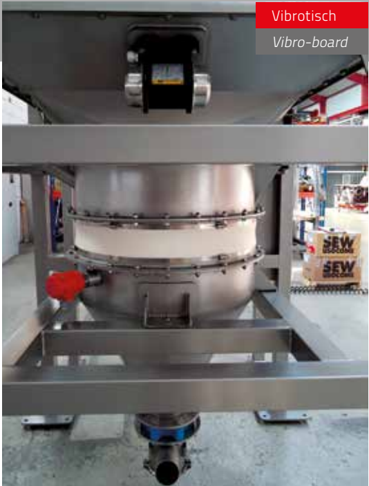
Staubarme Andockstation (mechanisch) Dust protected docking station - mechanical
